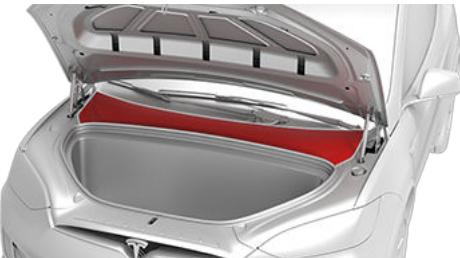
3. Tagliare in due punti il circuito di primo soccorso per rimuovere un'intera sezione.
