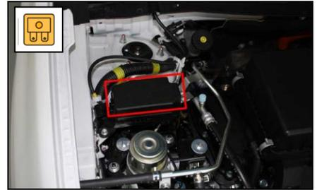
2. „Power Unit Control“-Sicherung entfernen (Nr. F7, 10 A)
