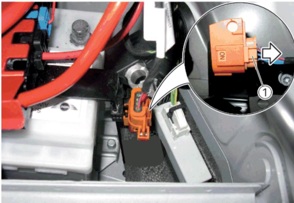
Sbloccare il connettore del punto di tranciatura per salvataggio ad alto voltaggio (1) e sfilarlo in direzione della freccia.
